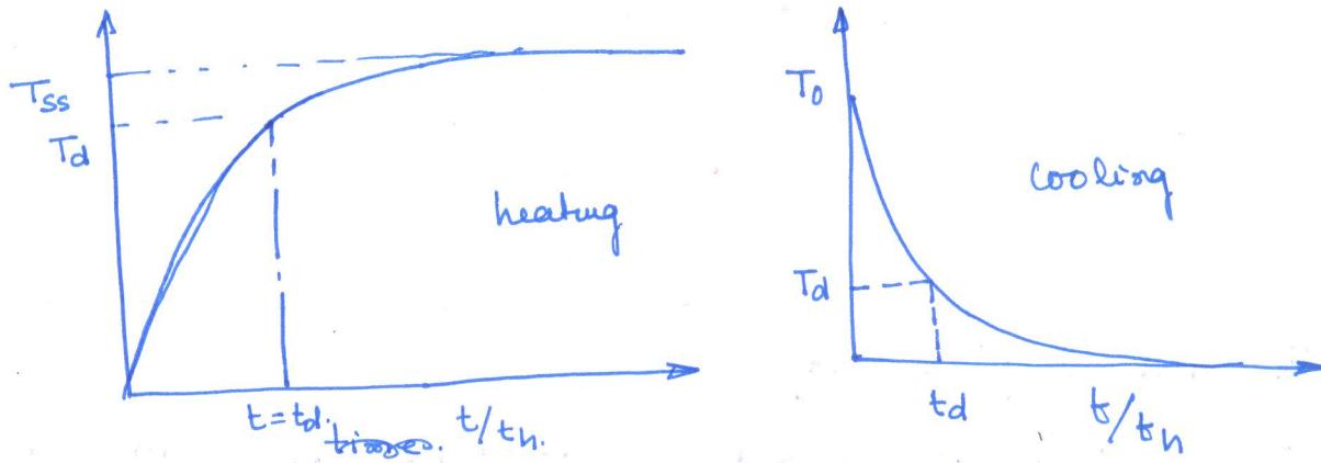
$$t_d = -t_h \ln \left[ 1 - \frac{T_d - T_{\infty}}{T_{ss} - T_{\infty}} \frac{h_c A_c}{R} \right]$$
